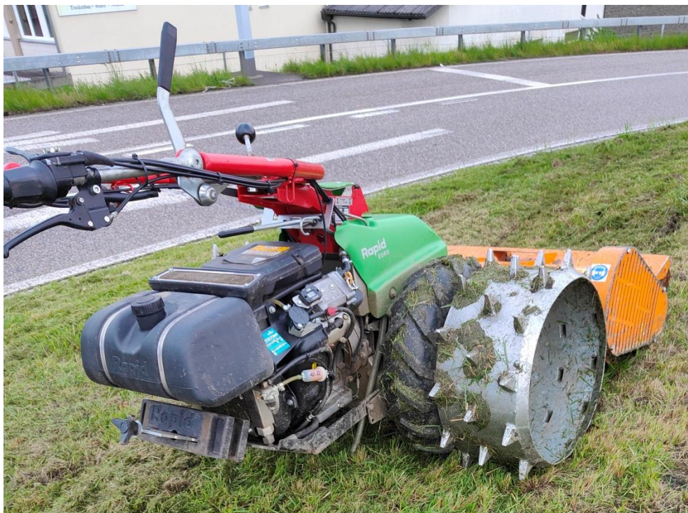
Rézsűn is közlekedni képes, fűnyíró adapterrel felszerelt munkagép.
