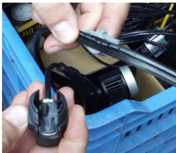
12V-os kisfeszültségű rendszer, LED lámpatestekkel, vezérlővel egybeépített transzformátorral, easy-lock kábelcsatlakoztatással.
