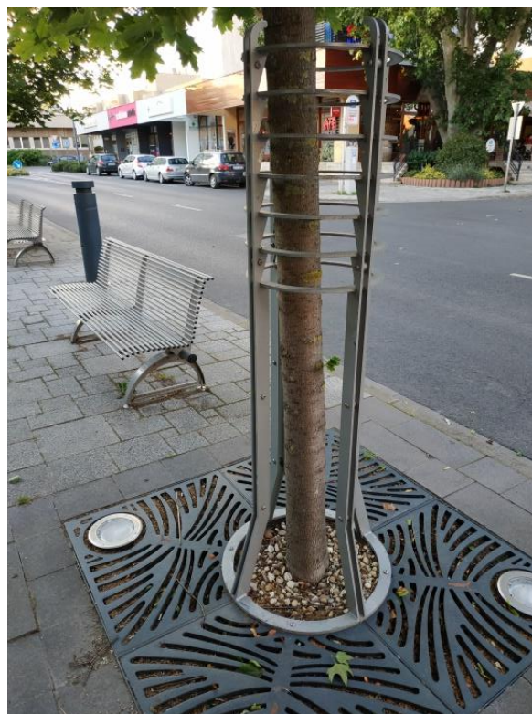
Korosfa átültetést követő horgonyzás és csurgó-védelem (Városliget). Faverebrács és favédőbrács Szombathely belvárosában.
