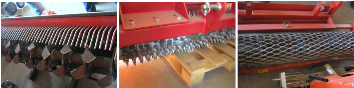
Egyemenetes fűmagvetés adapterei: talajmaró, tüskés henger, barázdás henger.
