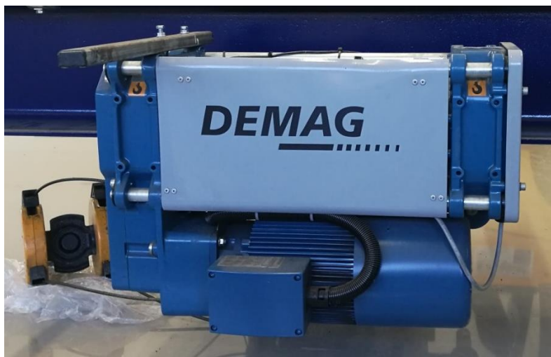
Villamos motorral hajtott sodronyköteles emelőmű (csarnoki futódaru része).
