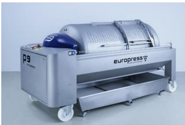
70. ábra Pneumatikus prés - Harasztné, 2012.
