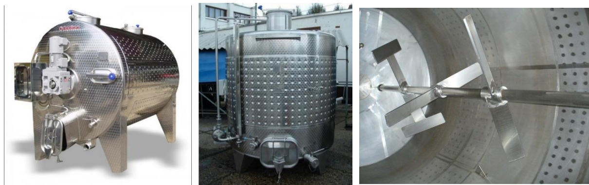
73. ábra Korszerű erjesztőberendezések - Harasztiné, 2012.
