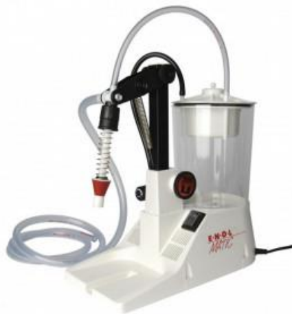
97. ábra Enolmatic palacktöltő berendezés - borkeszites.hu
