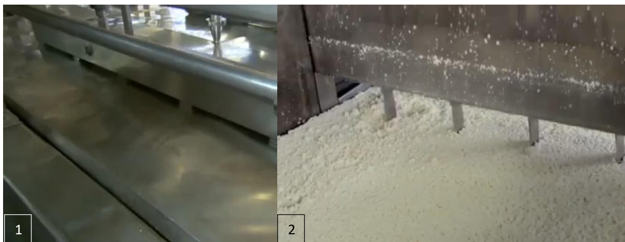
28. ábra Tebel-rendszerű alvadékpérelő-formázó (Internet 63)
